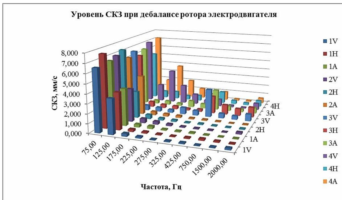
Рисунок 18 – Уровень СКЗ при дебалансе ротора электродвигателя
