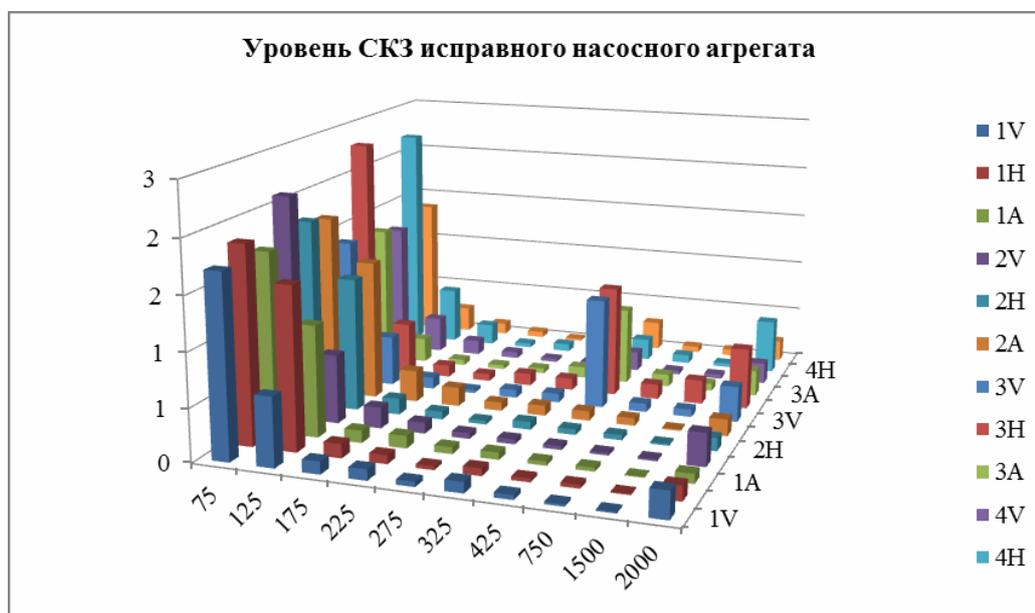
Рисунок 27 – Уровень СКЗ исправного ЦНА
