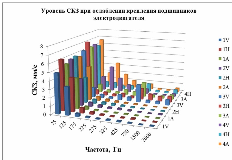
Рисунок 24 – Уровень СКЗ при ослаблении крепления подшипников
