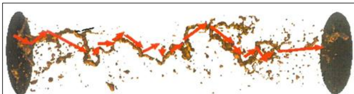
Рисунок 3.4 РКТ образца керна с системой гидродинамически связанных каверн после фильтрации через образец керна кислоты.
