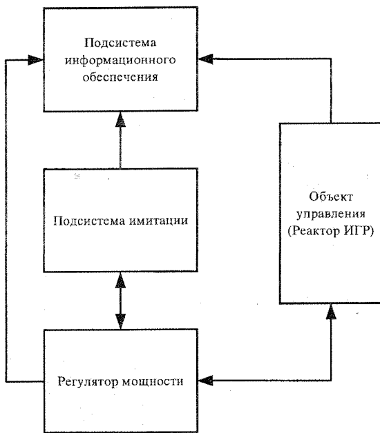
Рис. 3. Структурная схема системы автоматического регулирования мощности реактора ИГР
