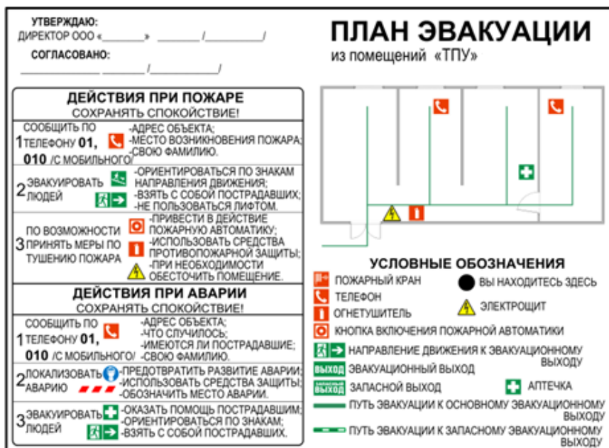
Рисунок 13 – План эвакуации при пожаре из помещений ТПУ
