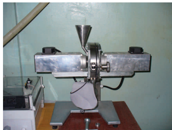
Рис. 5. Лабораторный дезинтегратор Дез-11
