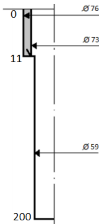
Рисунок 2.1. Типовая конструкция скважины
