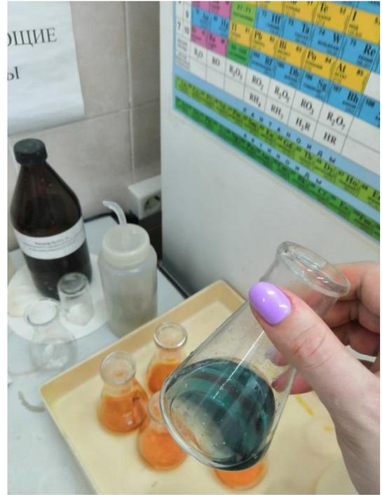
Рисунок 11 – Титрование проб раствором соли Мора
