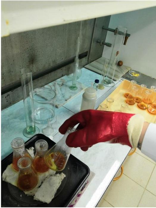
Рисунок 10 – Нагревание навесок с бихроматом на электроплитке
