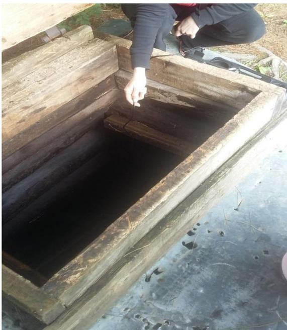
Рисунок 6 – Определение pH, температуры и УЭП с помощью мультипараметрового измерителя HI991301
