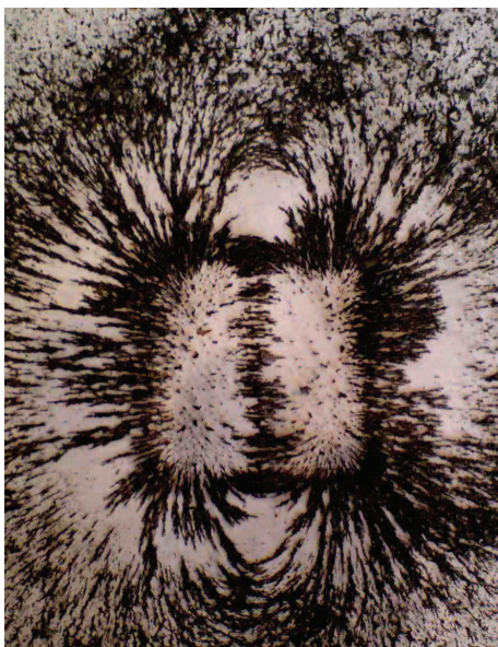
Рис. 2. Конфигурация магнитного поля, созданного парой плоских прямоугольных магнитов
