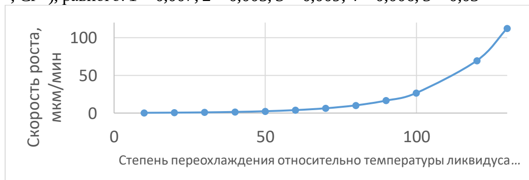
Рисунок 5 – Изменение скорости роста сферолитов ( v_p ) от степени переохлаждения относительно температуры ликвидуса ( \Delta T )
