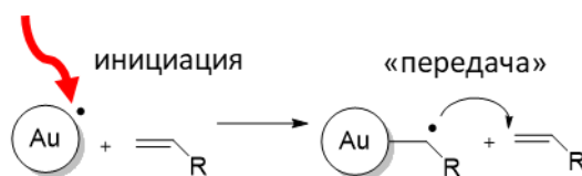
Схема 19. Механизм прохождения радикальной плазмон-индуцированной полимеризации
