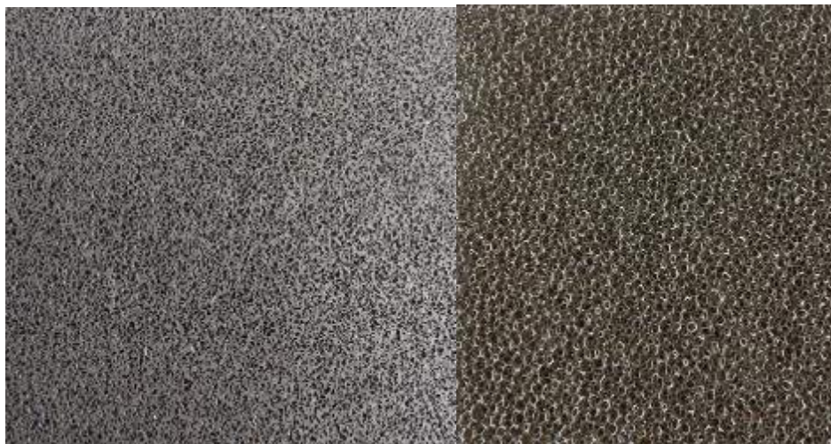
Рисунок 6.18 – Пенометалл, используемый в разрабатываемых конструкциях бронепластин
