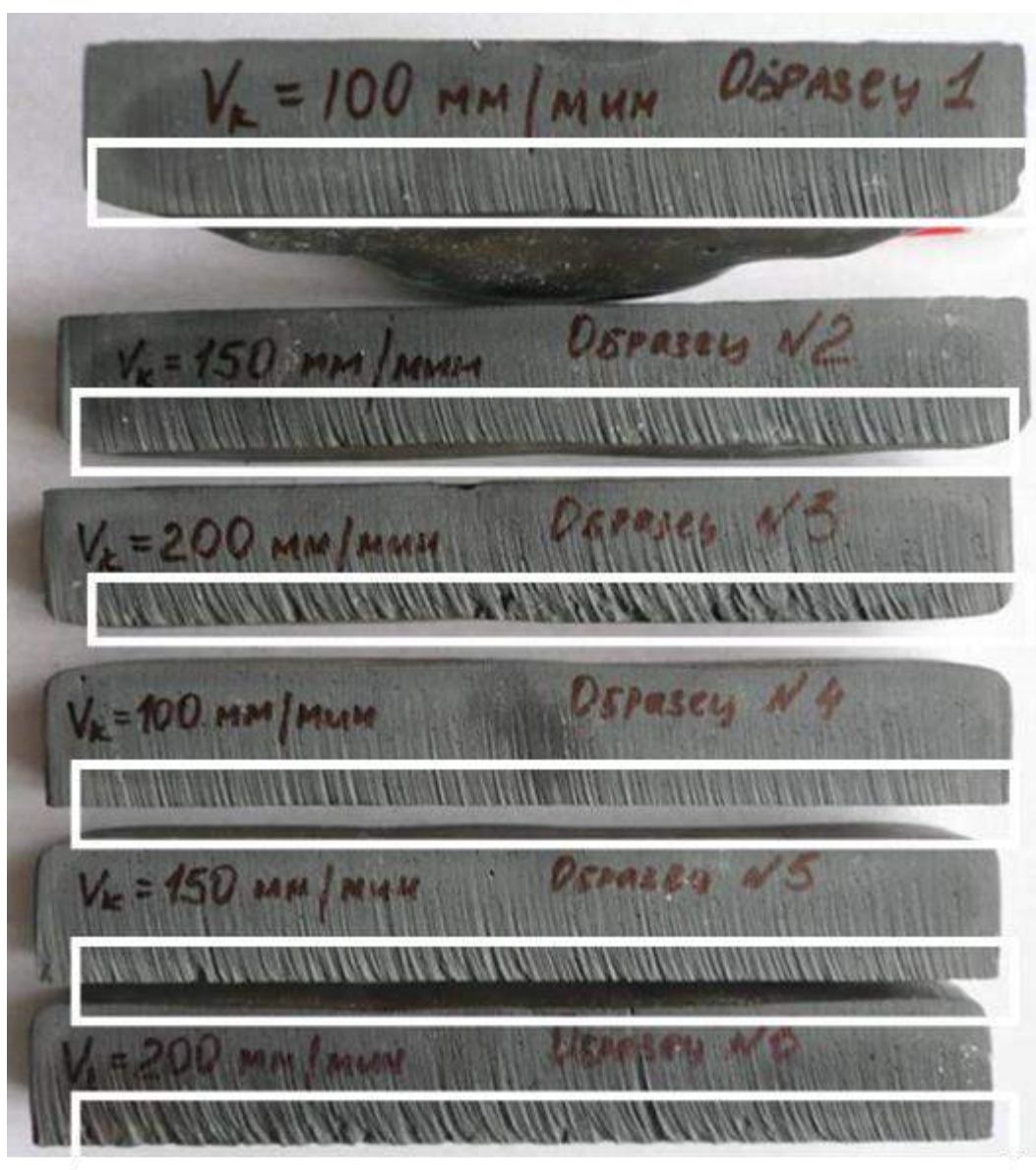
Рисунок 6.10 – Поверхность реза литых стеклокристаллических материалов (штриховые участки реза выделены белыми рамками)
