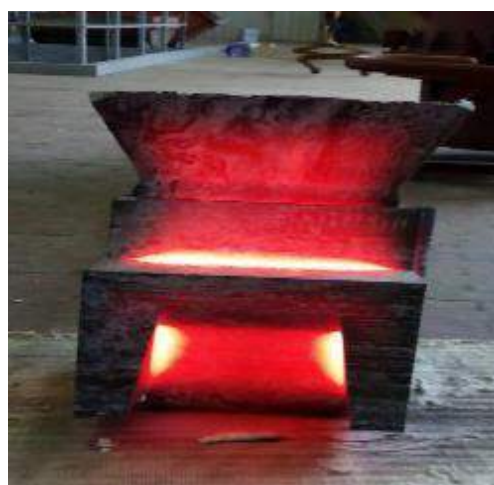
Рисунок 6.7 – Отливка, извлеченная из кокиля перед отжигом
