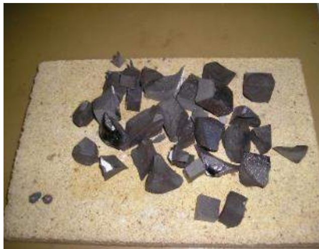
Рисунок 5.24 – Образцы литого стеклокристаллического материала с добавками отходов ОАО «ПЗГО» после 10 теплосмен
