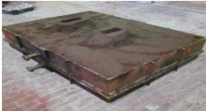
Рисунок 6.2 – Разовая форма перед заливкой
