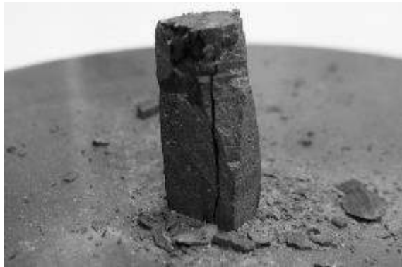
Рисунок 5.26 – Образец литого стеклокристаллического материала шпинелид-пироксенового состава с добавкой хромовой руды после испытания на определение предела прочности при сжатии
