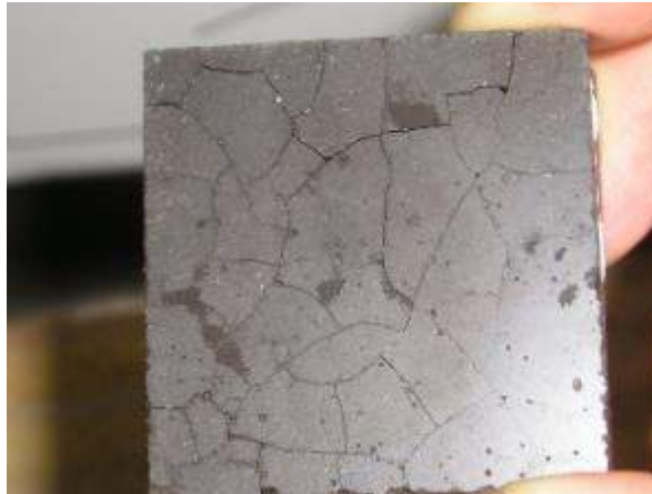
Рисунок 5.23 – Образцы литого стеклокристаллического материала с добавками отходов Качканарского ГОКа после 140 теплосмен
