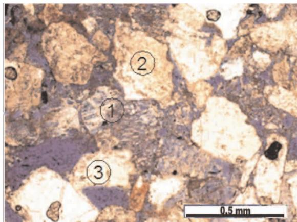
**Рис. 1.** Интенсивно растворенные обломки полевого шпата (1) и кварца (2, 3) в песчанике с объединенным пустотным пространством. Скв. Хиглинская-1, яковлевская свита, гл. 2038,0 м.  $U=0,71\text{ g/t}$ . Николи //. Увеличение 10
