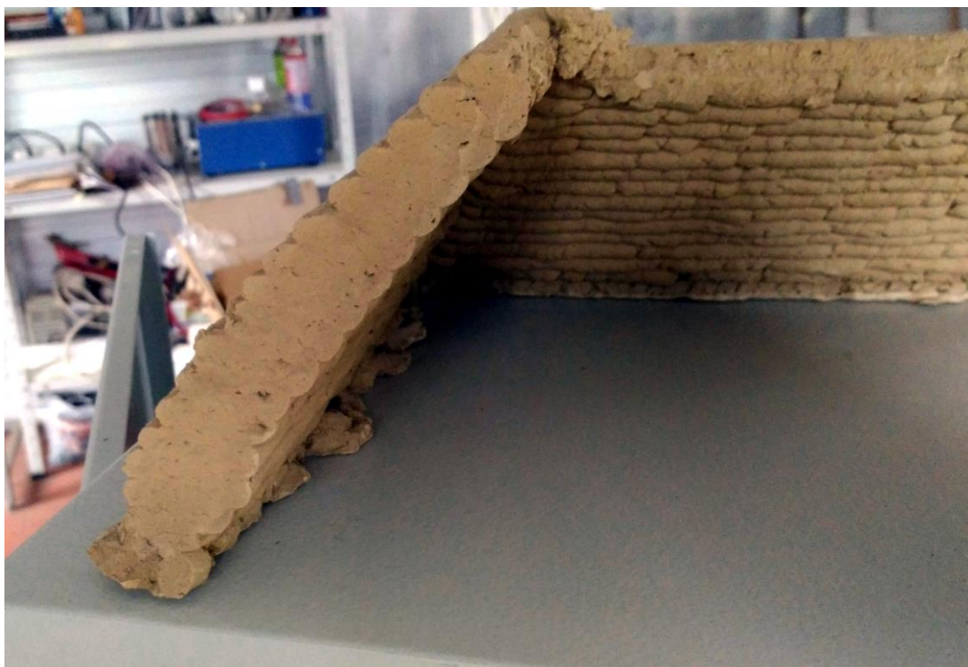
Рисунок 2. Напечатанная стенка в разрезе
