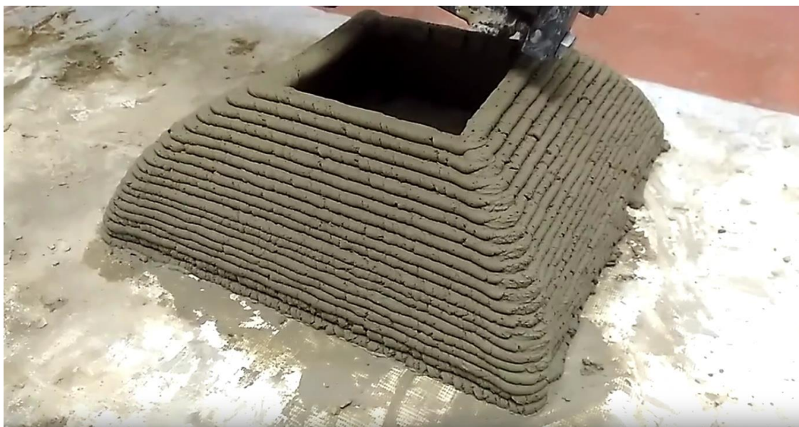
Рисунок 3. Попытка печати с отклонением 60 градусов от вертикали
