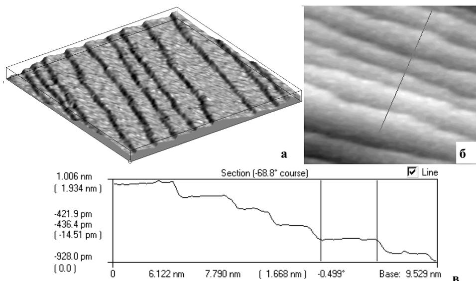
Рис. 3. Трехмерное а) и двухмерное б) СТМ изображения ( $139 \times 135 \text{ nm}^2$ ) чистой поверхности  $\text{Pt}_3\text{Ti}$  (510) и распределение по высоте и ширине (в), соответствующее линии на рис. б
