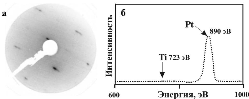
Рис. 2. ДЭНЭ изображение: а) и РИМЭ спектр б) чистой поверхности  $Pt_3Ti$  (510)
