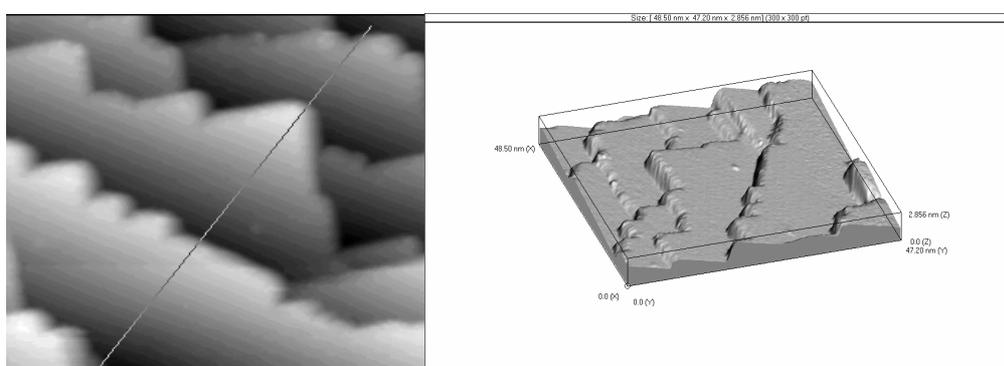
**Рис. 9.** Двухмерное и трехмерное СТМ изображения поверхности  $Pt_3Ti$  (510), окисленной при  $P=3 \cdot 10^{-4}$  Па,  $T=773$  К,  $t=720$  с. Область сканирования  $48,5 \times 47,2$  нм<sup>2</sup>
