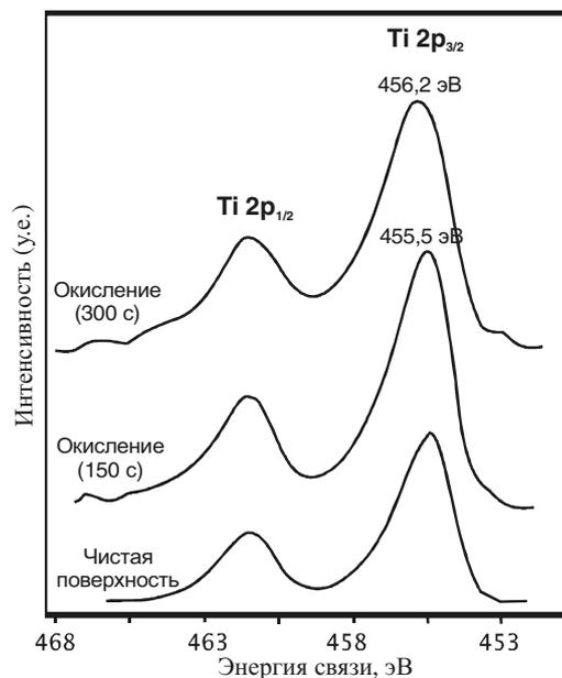
Рис. 6. РФЭС-спектры в области Ti2p для чистой и окисленной поверхности Pt<sub>3</sub>Ti (510)
