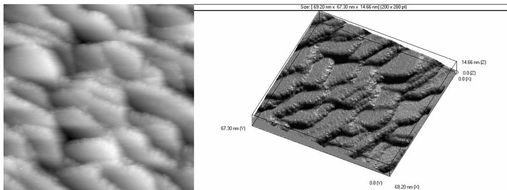
**Рис. 8.** Двухмерное и трехмерное СТМ изображения поверхности  $Pt_3Ti$  (510), окисленной при  $P=3 \cdot 10^{-4}$  Па,  $T=773$  К,  $t=300$  с. Область сканирования  $69,2 \times 67,3$  нм<sup>2</sup>
