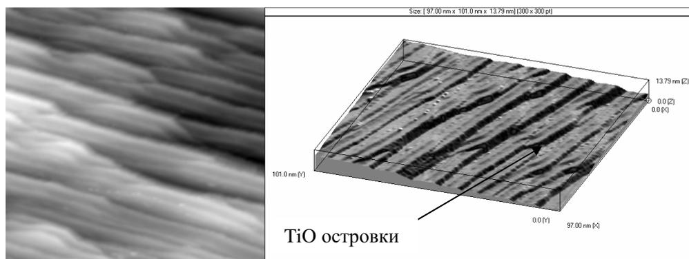
Рис. 7. Двухмерное и трехмерное СТМ изображения поверхности Pt<sub>3</sub>Ti (510), окисленной при P=3·10<sup>-4</sup> Па, T=773 К, t=150 с. Область сканирования 97×101 нм<sup>2</sup>
