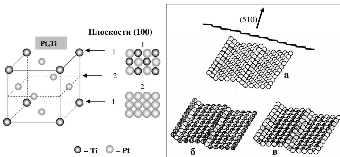
Рис. 1. Кристаллическая решетка  $Pt_3Ti$  ( $L1_2$ ) и схема ступенчатой поверхности  $Pt_3Ti$  (510). Возможные варианты состава террас плоскости (510): а) состоящие только из атомов платины; б, в) из атомов платины и титана
