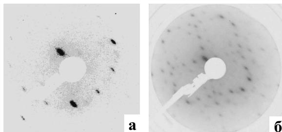
Рис. 5. ДЭНЭ изображения окисленной поверхности Pt<sub>3</sub>Ti (510) при P=3·10<sup>-4</sup> Па, T=773 К и времени окисления: а) 150 с, б) 300 с
