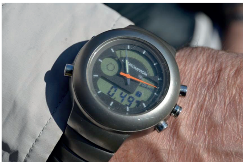
Рис. 4. Мощность экспозиционной дозы над ручьём в воздухе на высоте 1 м, мкЗ/ч
