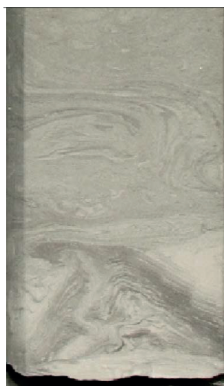
Рис. 3. Деформационная текстура, развитая во время отложения алевритопесчаного осадка. Ем-Еговская площадь, скв. 30034Р, горизонт ВК 1 , инт. 1496,65–1496,80 м
