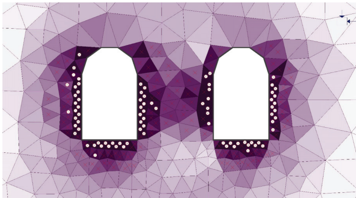
Рис. 4. Зоны распределения вероятности разрушения массива в заданных интервалах граничных условий (разрез по простиранию)
