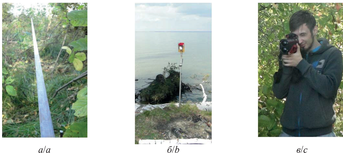
Рис. 9. Геодезический мониторинг береговой линии: а) применение геодезической рулетки; б) выполнение геодезических измерений; в) измерение с использованием лазерной рулетки
