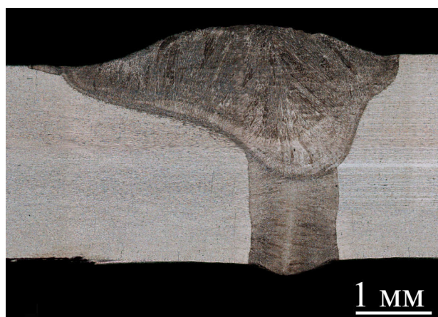
Рис. 2. Структура сварного шва стали 12X18H10T, полученного методом гибридной лазерной сварки
