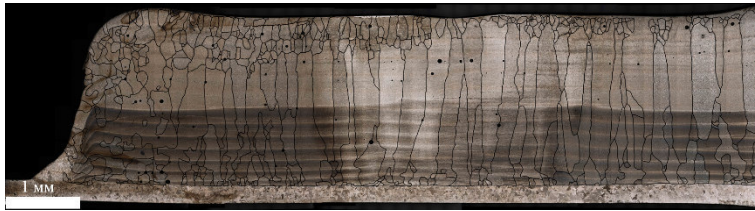
Рис. 1. Макроструктура материала в продольном сечении титановой стенки, полученной методом проволочной аддитивной электронно-лучевой технологии
