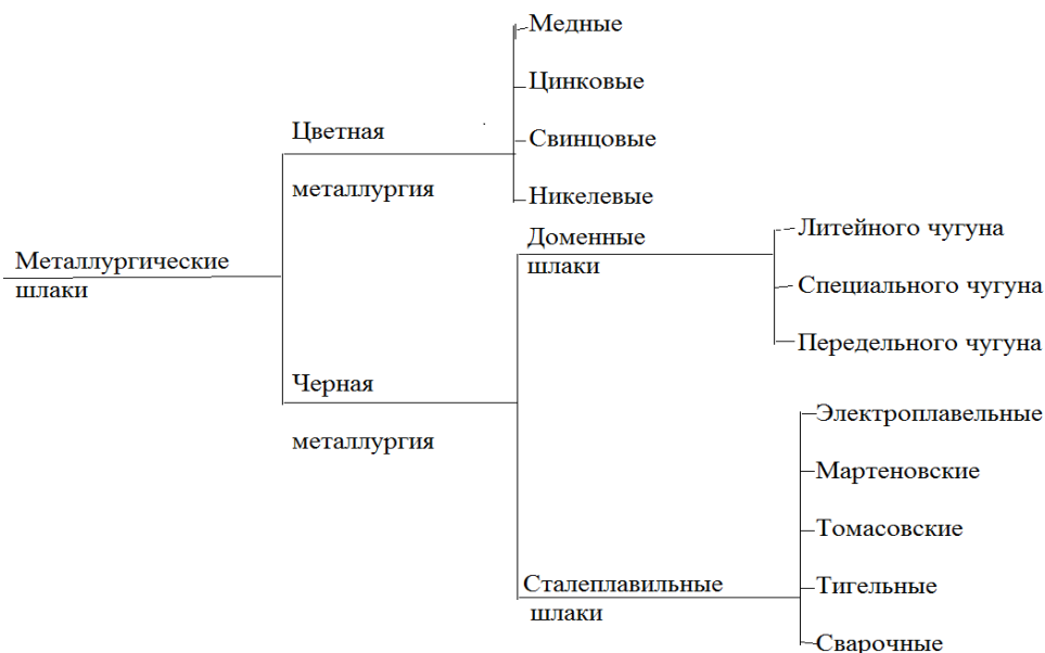
Рис. 1. Классификация металлургических шлаков
