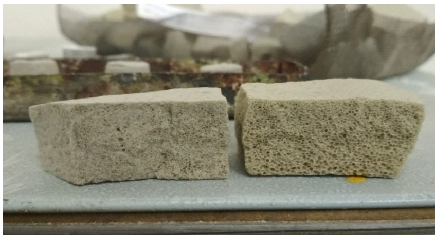
Рис. 1. Влияние количества жидкого стекла на пористость
