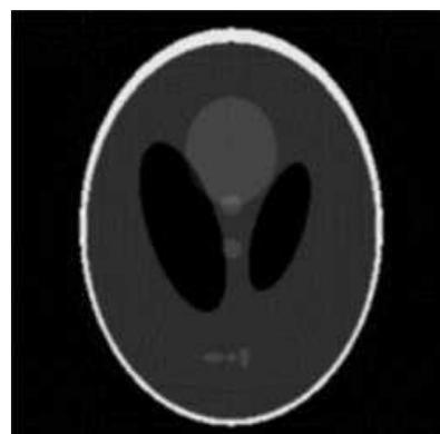
Рисунок 9. Реконструкции методом прямого интегрирования (270 проекций, шаг  $1^\circ$ )
