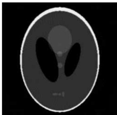
Рисунок 8. Результат реконструкции по алгоритму ФОП (270 проекций, шаг  $1^\circ$ )
