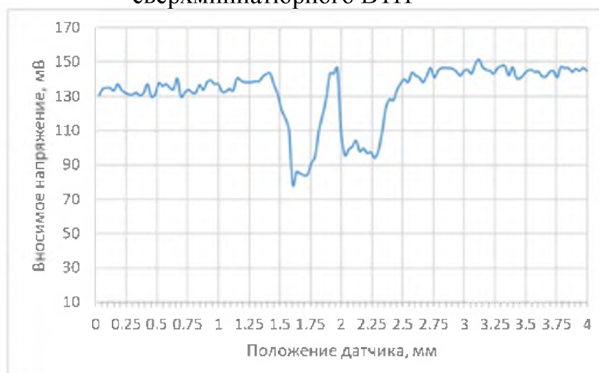
Рисунок 7. б. Результаты сканирования при перемещении датчика над слоистой средой металл-полиэтилен-металл с использованием обычного ВТП.
