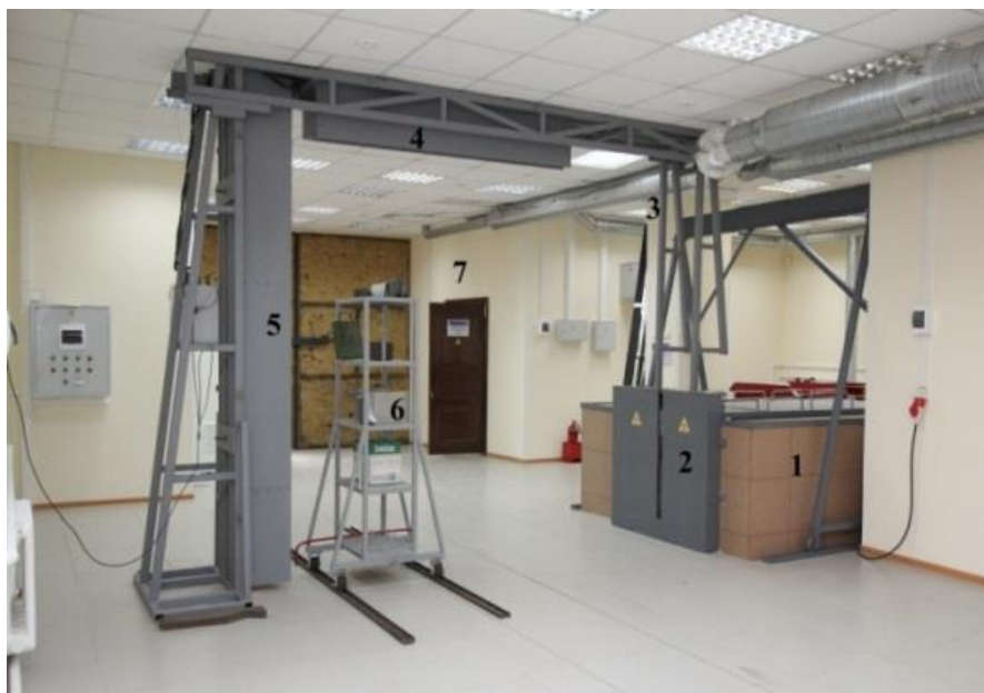
Рисунок 1.1 - Цифровая радиографическая и томографическая система неразрушающего контроля: 1 – бокс с бетатроном МИБ-9, 2 – коллиматор, 3 – детекторный портал, 4 – горизонтальная линейка детекторов, 5 – вертикальная линейка детекторов, 6 – полки с тестируемыми материалами, 7 – операторская
