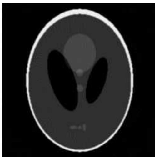
Рисунок 3.9 - Результат реконструкции по алгоритму ФОП (270 проекций, шаг 1 °)
