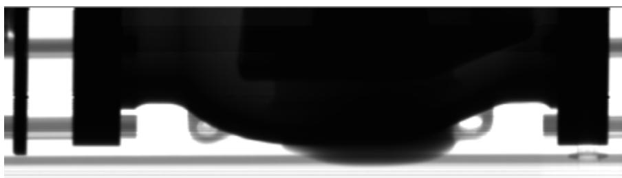
Рисунок 4.7 - Радиограммы P2: а – без применения фильтров, б – с выделением деталей на малой толщине, в – с выделением деталей на большой толщине (гамма-коррекция), г – Профиль на более тонком участке, д – Профиль на более толстом участке
