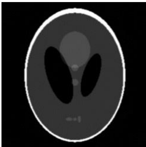
Рисунок 3.12 - Результат, полученный с помощью ФОП при использовании 360 проекций вместо 270
