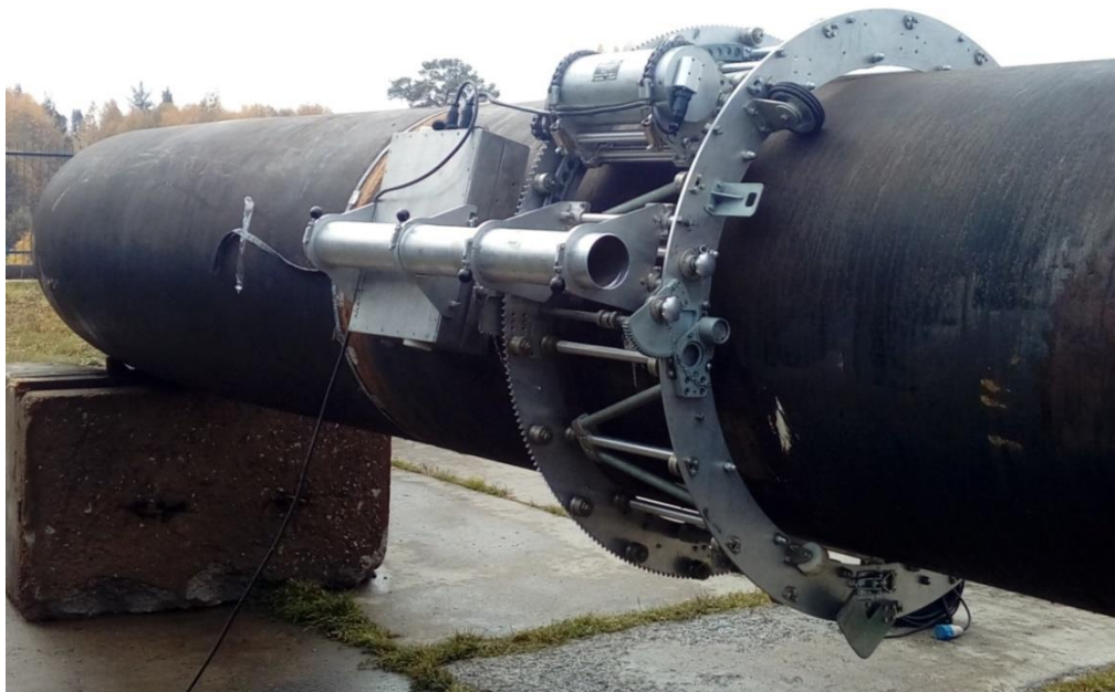
Рисунок 2.6 - Опытный образец автоматизированного мобильного дефектоскопа
