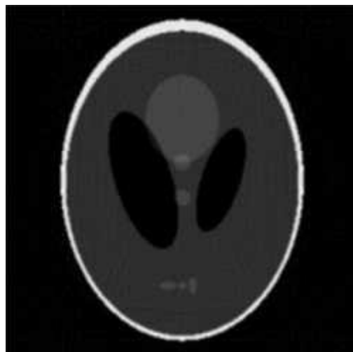
Рисунок 3.1 - Результат реконструкции методом прямого интегрирования, 270 проекции, шаг 1^\circ
