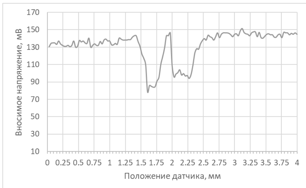
Рисунок 4.5.б – Результаты исследований структуры с размещенным модельным дефектом обычным ВТП, частота сигнала – 1000 Гц
