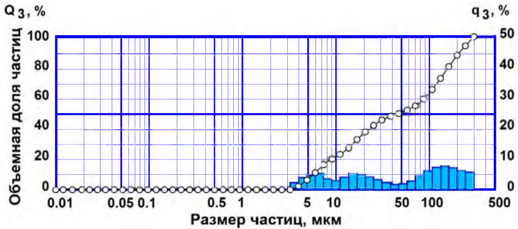
Рисунок 3.7 – Объемное дифференциальное и интегральное распределения частиц по размерам для \text{Li}_2\text{CO}_3
