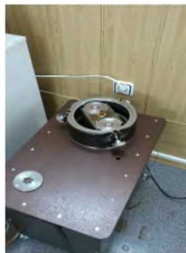
Рисунок 2.1 – Устройство (а) и вид (б) шаровой планетарной мельницы АГО-2С: 1 – 3 – элементы корпуса; 4 – крышка барабана; 5 – вал; 6 – полость водила; 7 – 9 – барабан; 10 – откидные болты
