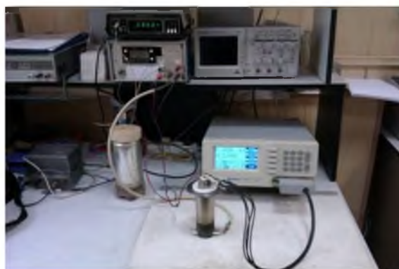
Рисунок 2.27 – Блок-схема (а) и вид (б) экспериментального стенда для измерения электрической проводимости
