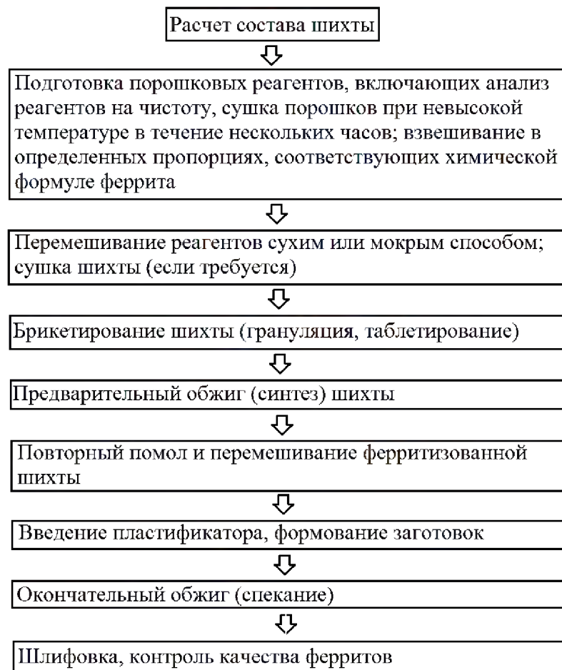
Рисунок 1.2 – Технологическая схема получения феррита керамическим методом
