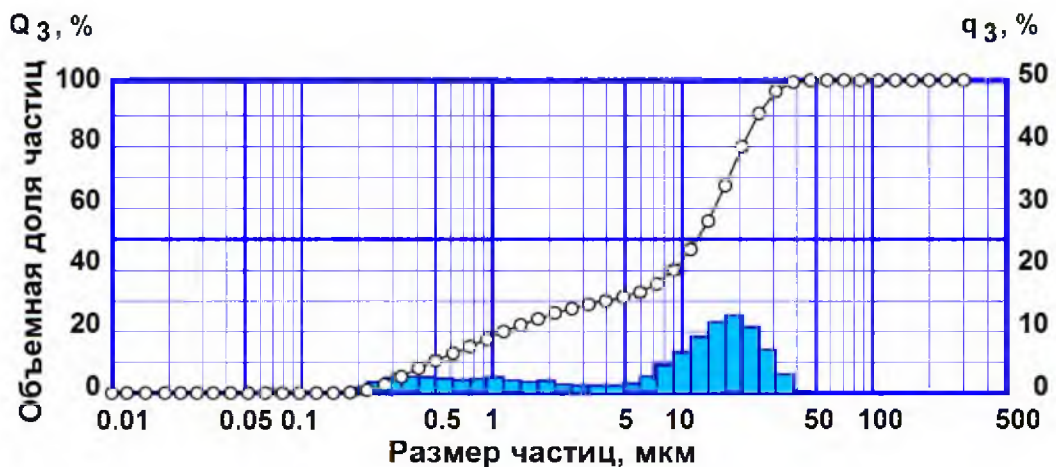
Рисунок 3.6 – Объемное дифференциальное и интегральное распределения частиц по размерам для \text{Fe}_2\text{O}_3
