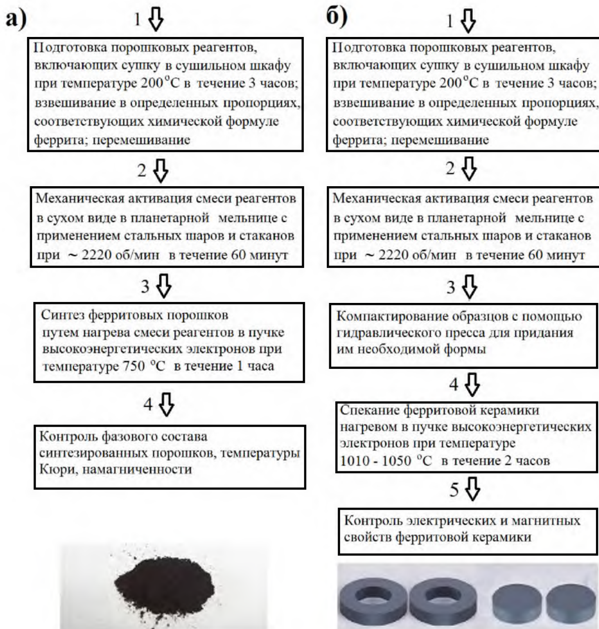
Рисунок 6.20 – Технологические схемы синтеза (а) и спекания (б) литиевых и литий-замещенных ферритов
