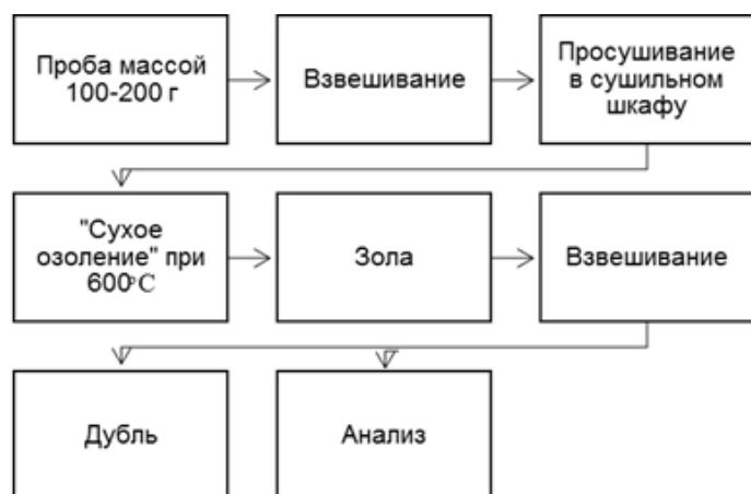
Рисунок 14. Схема обработки и анализа проб методом ИНАА
