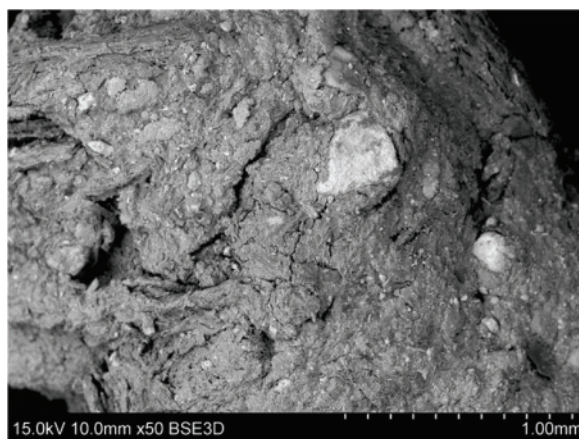
Рис. 4. Микрофотография поверхности гранулы биогумуса (увеличение x50).
