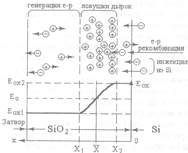
Рис. 6 Радиационные процессы образования и удаления заряда в окисле МОП-структуры (вверху) и распределение электрического поля в окисле (ниже)
