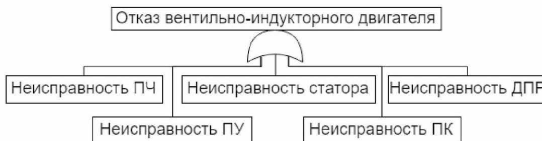
Рисунок 7 - Дерево отказов ВИД: ПЧ - преобразователь частоты; ДПР - датчик положения ротора; ПУ - подшипниковый узел; ПК - полупроводниковый коммутатор.
