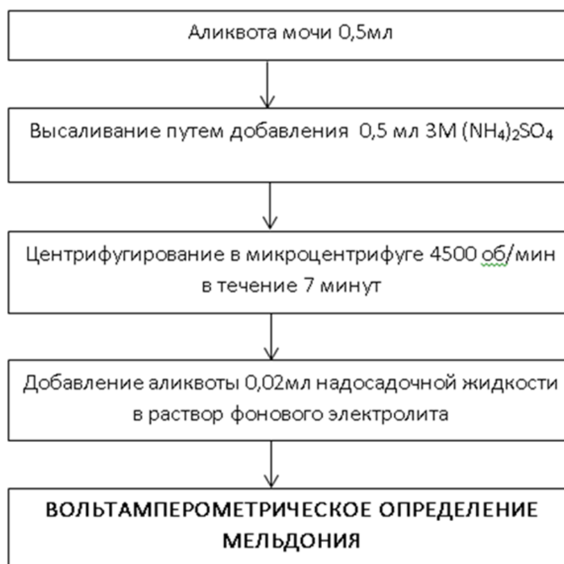
Рисунок 51 - Алгоритм пробоподготовки проб биологических объектов для вольтамперометрического определения мельдония
