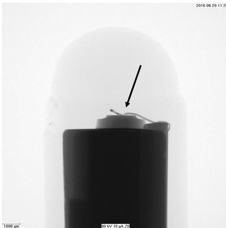
Рисунок 3.4 – Фотография СД с перегоревшим электрическим выводом при проведения ступенчатых испытаний, полученная на рентгеновском микроскопе Phoenix microme|x Microfocus X-ray System. Стрелкой показано место разрыва электрического вывода
