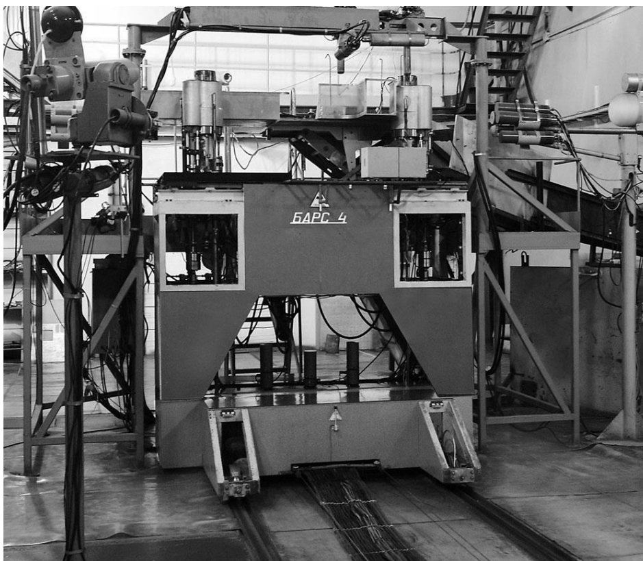
Рисунок 2.22 – Импульсный твердотопливный двухзонный ядерный реактор на быстрых нейтронах
