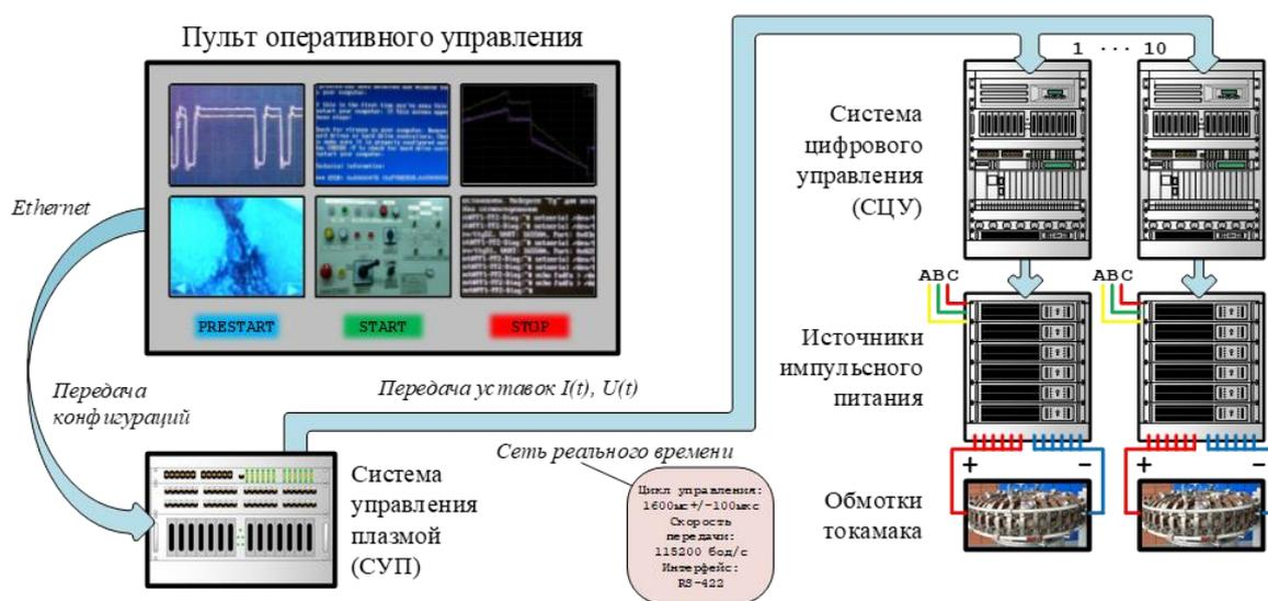
Рис. 1. Схема передачи управляющих воздействий
