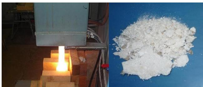
Рис. 1. Плазменный стенд «Высокочастотный факельный плазматрон на базе генератора ВЧГ8-60/13» для исследования процесса плазменной иммобилизации ИЛО
