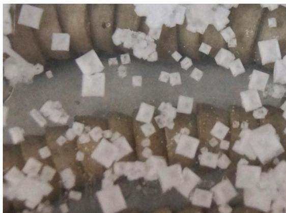
Рис. 1. Кристаллы NaCl, формируемые при  $a - B = 0$  мТл.
