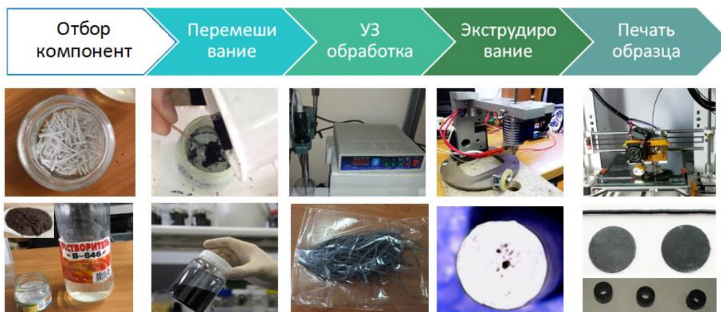
Рисунок 1 - Схема получения композиционного радиофиламента
