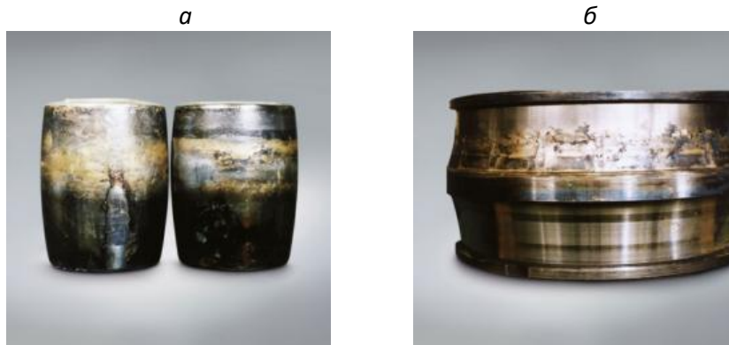
Рис.6. Дефект двухрядного подшипника:
