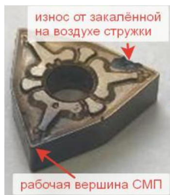
Рис. 2. Износ поверхности СМП от стружки
