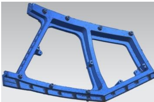
Рис. 4. 3D модель заготовки с равномерным припуском 6 мм
