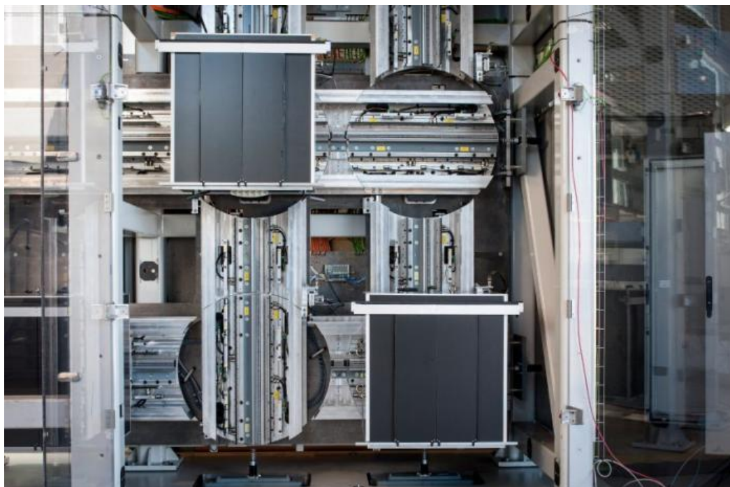
Рис. 1. Макет лифта с технологией линейного двигателя
