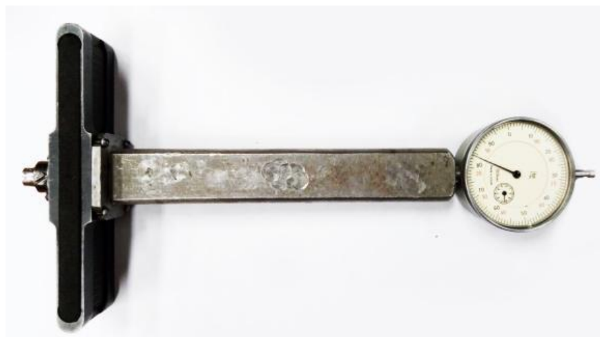
Рис. 1. Динамометрическая оправка с симметричной плоской пружиной для алмазного выглаживания (силовой элемент – плоская пружина)
