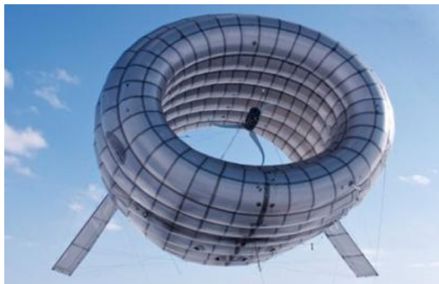
Рис. 2. Ветрогенератор-дирижабль Airborne Wind Turbine [1]
