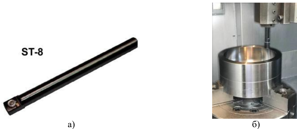
Рис. 4. Инструмент и пример отделочно-упрочняющей обработки внутренней поверхности
