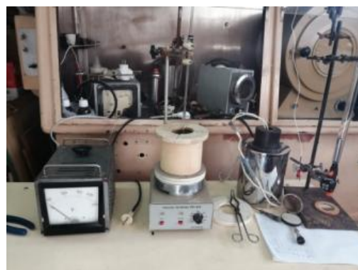
Рис. 1. Схема установки для проведения экспериментов с образцами лесных горючих материалов 1 – автотрансформатор; 2 – муфельная печь; 3 – контейнер с образцом; 4 – измеритель температуры; 5 – штатив.
