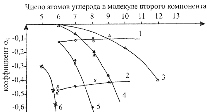
Рис. 1. Зависимости коэффициентов \alpha_{ij} для расчета вязкости некоторых рядов бинарных смесей: 1 — гексан-арен; 2 — циклогексан-арен; 3 — гексан-алкан; 4 — бензол-арен; 5 — бензол-алкан; 6 — циклогексан-алкан
