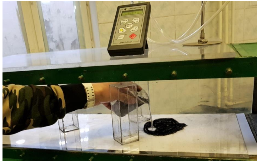
Рис. 2. Общий вид рабочей камеры аэродинамической трубы с установленными в ней моделями из оргстекла
