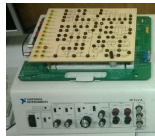
Рис. 2. Плата со схемами аналоговой радиоэлектроники на станции ELVIS
