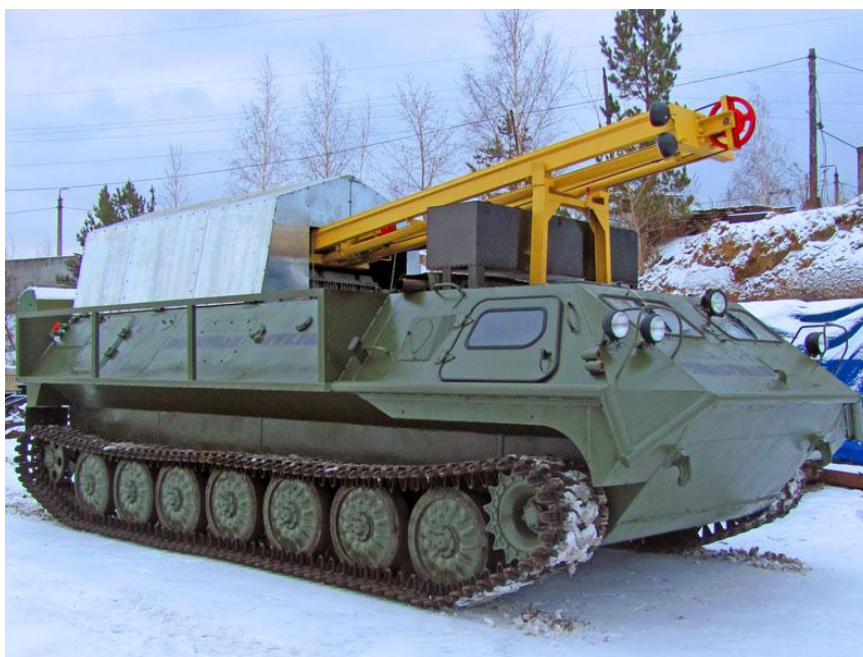
Рисунок 3.2 – Буровая установка УБР-2А2, смонтированная на вездеходе МТЛБ
