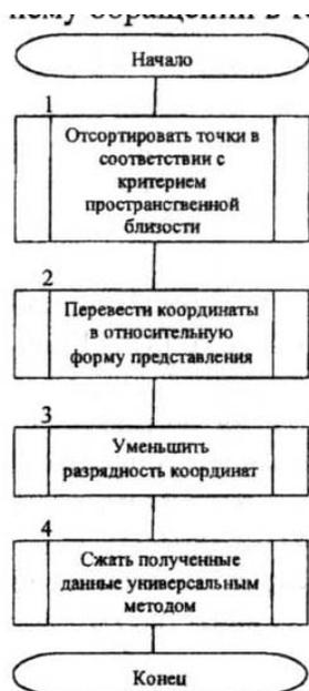
Рис. 3. Укрупненная схема алгоритма сжатия точечных геоданных
