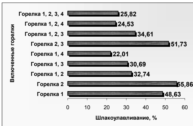
Рис. 6. Осаждение золовых остатков (%) в топке котла БКЗ-220-100ЖШ при перераспределении нагрузки на разные горелки.
