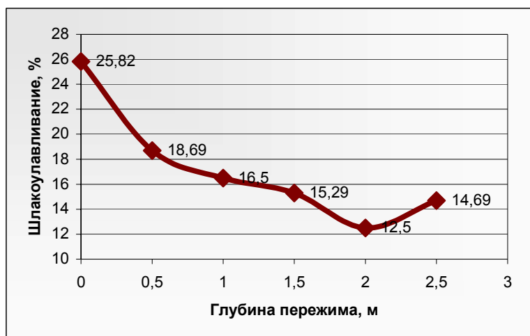
Рис. 9. Осаждение золовых остатков в топке котла БКЗ-220-100ЖШ при различной глубине пережима на тыльной стороне
