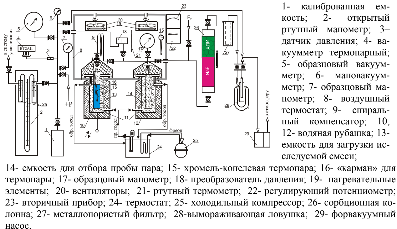
Рис. 6. Схема экспериментальной установки изучения давления насыщенного пара HF и кинетики термического разложения диазониевой соли
