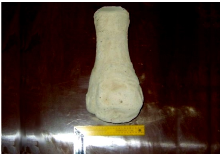
Рис. 4. Электронабивная свая второго типа (глубина скважины 5 – 6 м)
