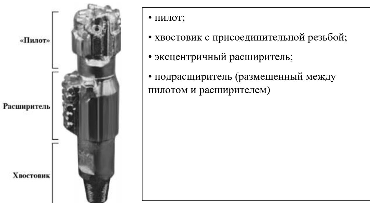
Рисунок 13 – Конструкция бицентричного долота типа PDC.
