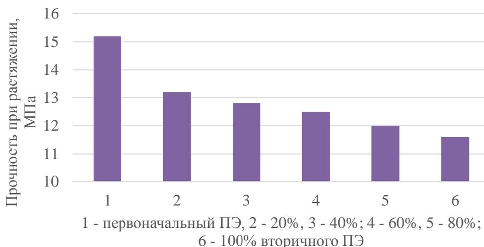
Рисунок 5 – Сравнение прочности материала от содержания в его составе вторичного полиэтилена [7]
