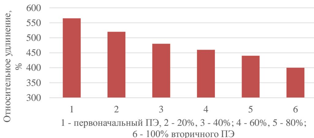
Рисунок 4 – Сравнение относительного удлинения материала от содержания в его составе вторичного полиэтилена [7]
