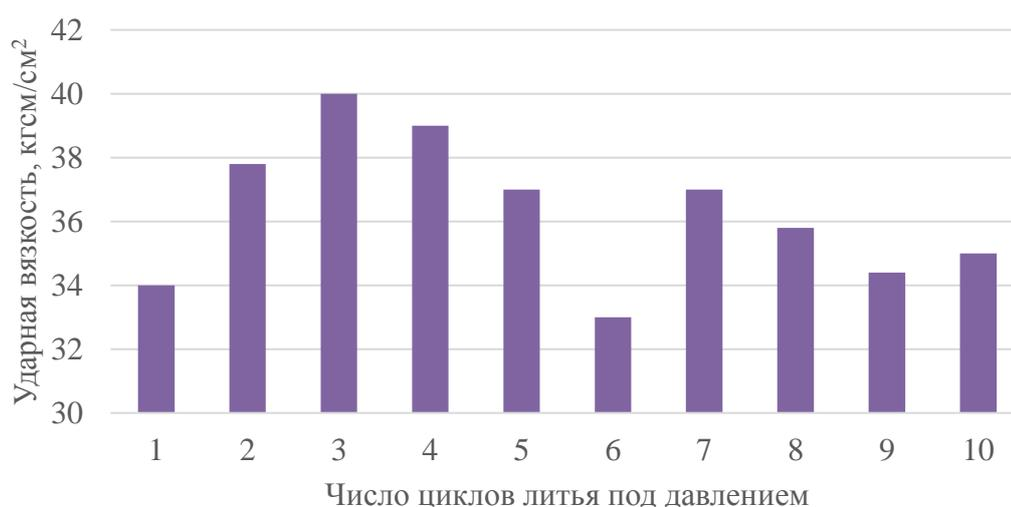
Рисунок 10 – Зависимость ударной вязкости полистирола от числа циклов переработки [7]
