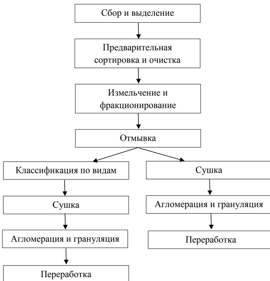
Рисунок – 1. Схема предварительной обработки полимеров
