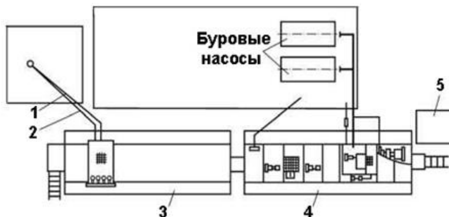
Рисунок 11 – Схематично стандартную циркуляционную систему (ЦС100Э) можно представить следующим образом:
