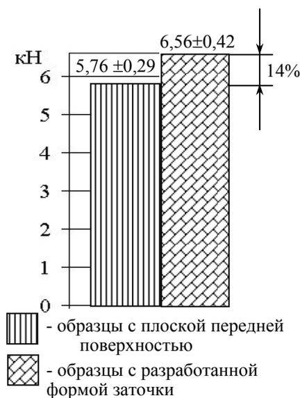
Рис. 9 Гистограмма усилий разрушения образцов
