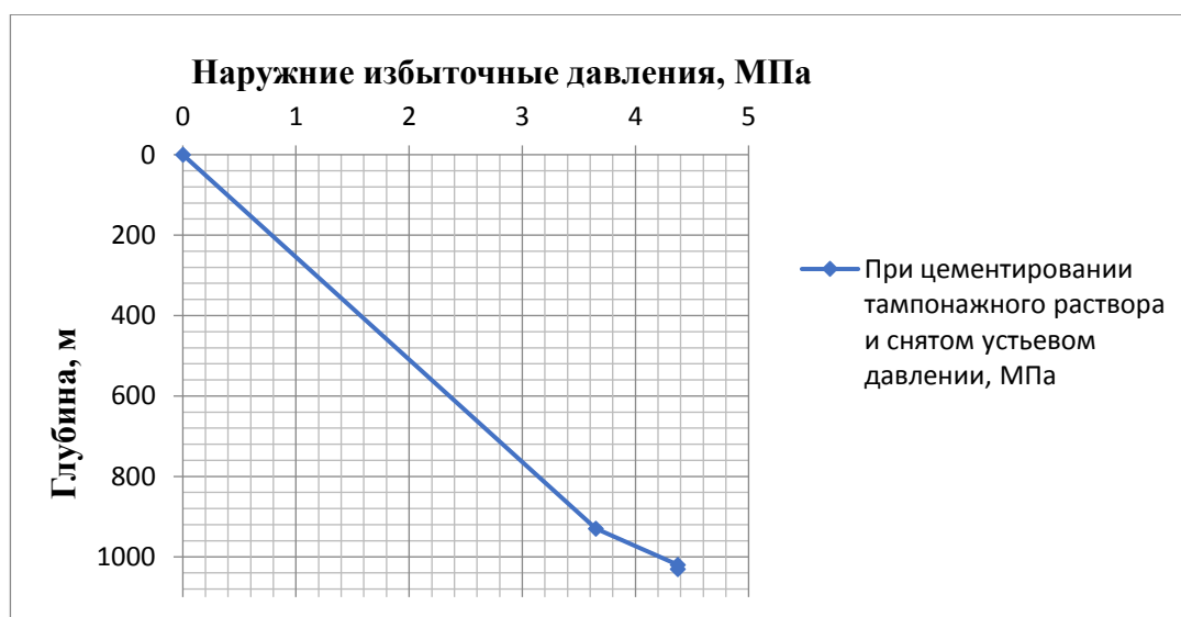
Рисунок 5 – Эпюра наружных избыточных давлений для кондуктора
