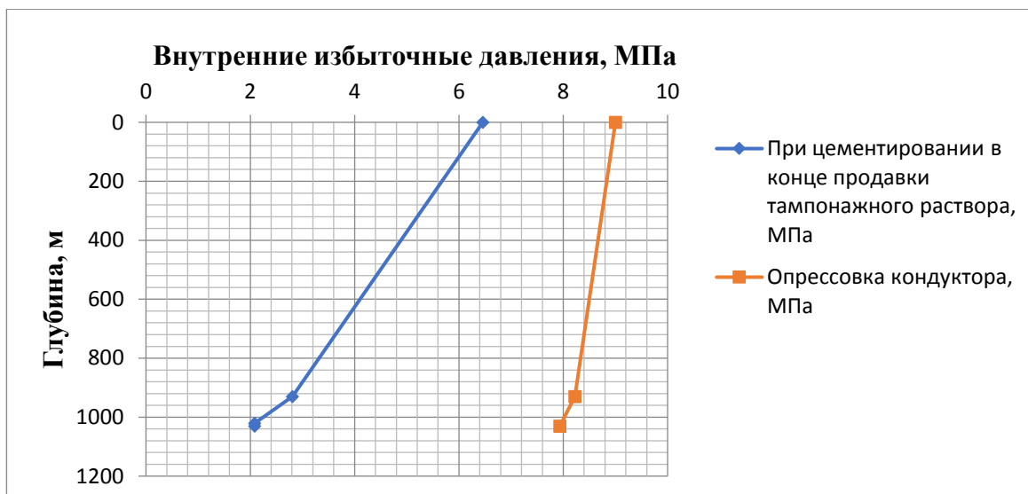
Рисунок 10 – Эпюры внутренних избыточных давлений для кондуктора
