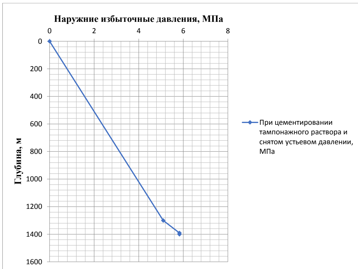
Рисунок 5 – Эпюра наружных избыточных давлений для кондуктора
