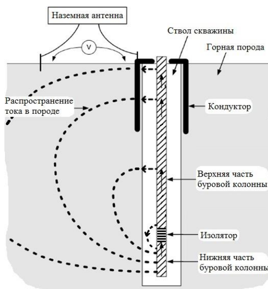
Рисунок 15 – Принцип работы СКД [1]
