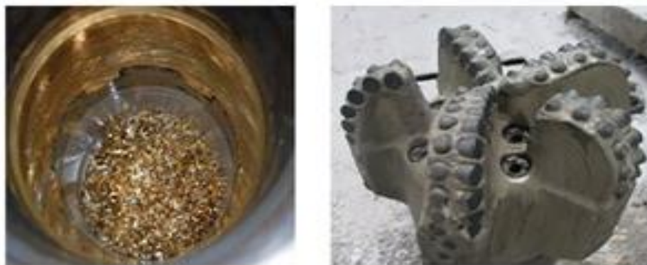
Рисунок 8 – Долото XCD разбуренное в лабораторных тестах; долото SDi516 без износа после разбурки XCD на месторождении Западной Сибири
