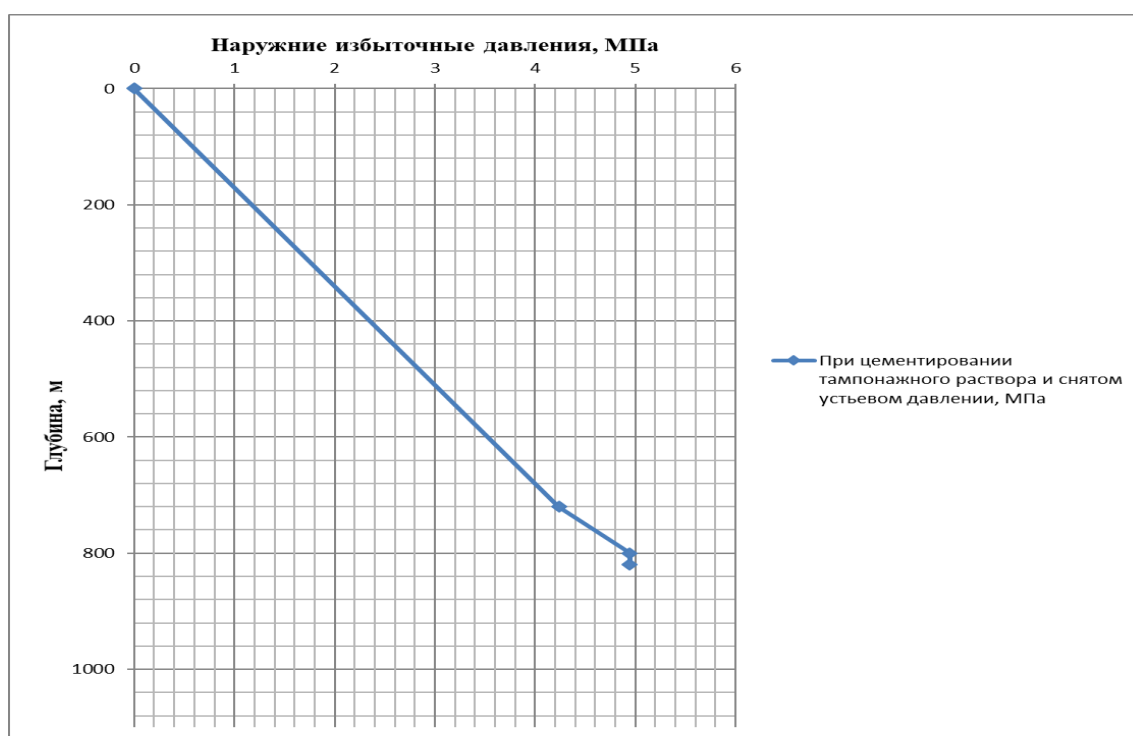
Рисунок 2 – Эпюра наружных избыточных давлений для кондуктора
