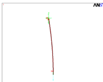
Рисунок 10 – Схема нагружения стержня при стационарном состоянии
