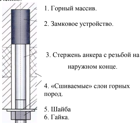
Рисунок 1 – Устройство горного анкера
