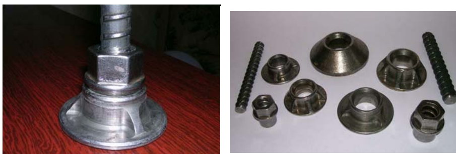
Рисунок 14 – Общий вид затяжного устройства анкерной крепи типа АК и его отдельных элементов
