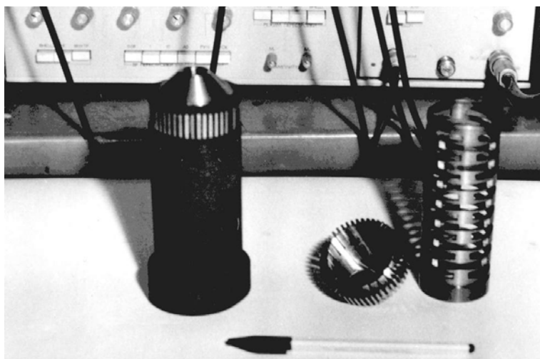
Рис.5. Внешний вид анодного блока ОКМ.
