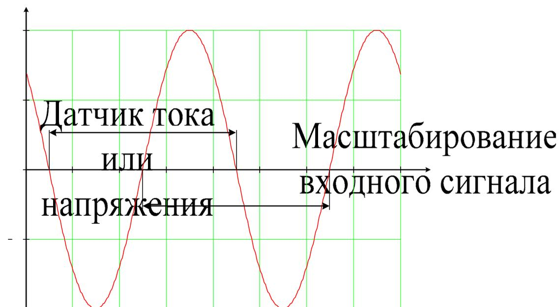
Рисунок 4 – Иллюстрация метода нахождения периода сигнала по нулевым переходам
